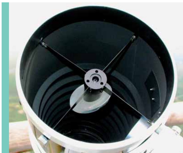
► Vista frontale dello strumento. Si notano gli anelli per abbattere i riflessi, lo spider con tutte le regolazioni che si possono desiderare e lo specchio secondario, anch'esso montato "nudo". Si vede come lo specchio sia montato in maniera vistosamente spostata rispetto al centro, come è normale che sia in un telescopio a f/4 . Piccola pecca, il bordo del secondario dovrebbe essere annerito, ma lo si può fare con un pennarellino (e tanta attenzione).
