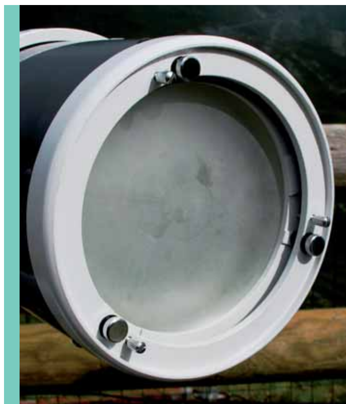
► La cella dello specchio primario, con il fondo dello specchio a vista e l'ottimo sistema di collimazione.
