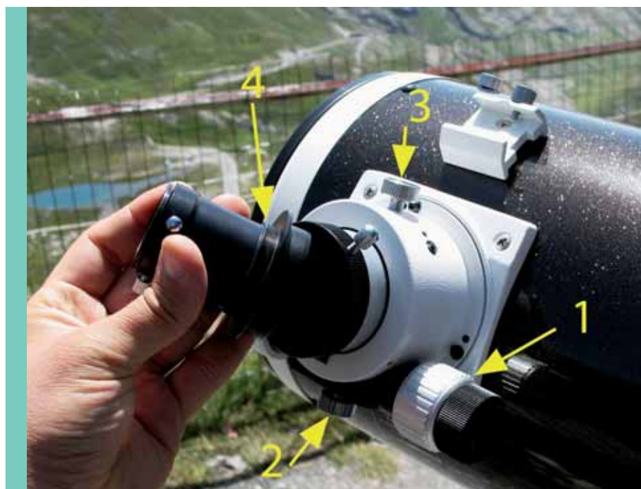
► Il bellissimo foceggiatore del WidePhoto . Si notano la manopola per il fuoco fine e rapido (1) la vite di regolazione della durezza (2) e di blocco (3) e il riduttore per oculari da 31,8 mm (4). Quest'ultimo si separa in due parti e la filettatura che si vede va su un normale anello T2. Tuttavia, questo pezzo non si monta quando è in uso il riduttore, che richiede un T2 wide .
